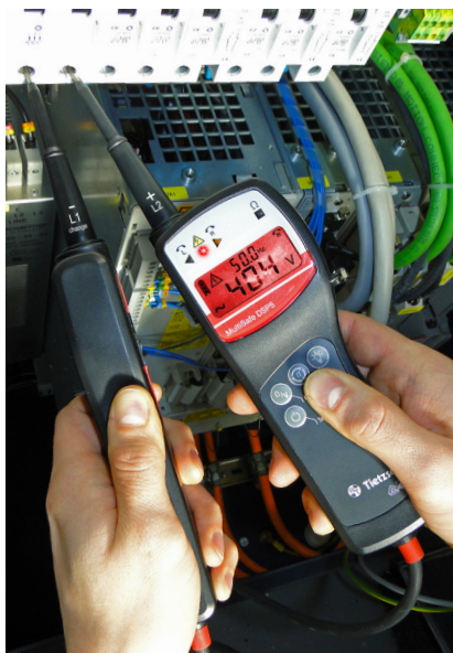
Připojitelná dodatečná zátěž pomocí tlačítek na zadní straně přístroje
