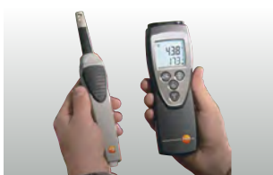
Testo 625 s rádiovou rukojetí a rádiovým modulem.
