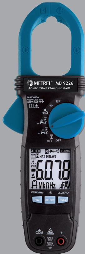
MD 9226 je profesionální DC a TRMS AC klešťový multimetr. Umožnuje také měřit kapacitu a kmitočet. Je vybaven digitální dolní propustí, což umožňuje měřit hodnoty generované frekvenčními měniči VFD. MD 9226 má širokou škálu dalších funkcí, včetně zachycení špičkové hodnoty rozběhového proudu nebo napětí, záznam hodnot MIN/MAX/AVG, funkci HOLD, automatické vypnutí, automatické přepínání rozsahů a relativní měření. Používá nejnovější měřicí technologie a je vestavěn v robustním pouzdře.
