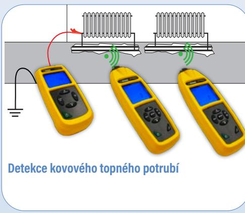
**Detekce kovového topněho potrubí**
